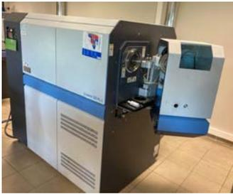
Figure 3 : Instrumentation GDMS de type Element GD
